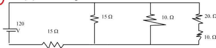
( $20\ \Omega$ ,  $6.0\ A$ ;  $90\ V$ ,  $6.0\ A$ ;  $30\ V$ ,  $2.0\ A$ ;  $30\ V$ ,  $3.0\ A$ ;  $20\ V$ ,  $1.0\ A$ ;  $10\ V$ ,  $1.0\ A$ )
