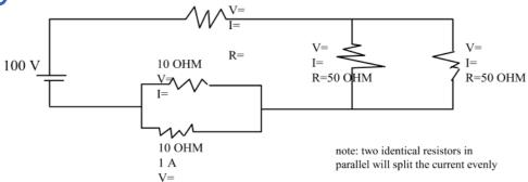
(40V 2A 20 OHM; 50V 1A; 50V 1A; 10V 1A; 10V)
